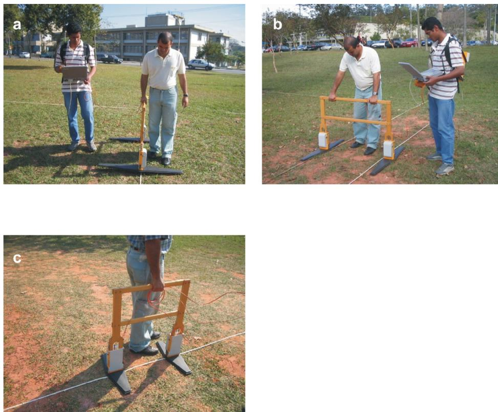
Figura 5.1 – Aquisições de campo passo a passo. a) arranjo Ey-Ey com antena de 100MHz, b) arranjo Ex-Ex com antena de 100MHz e c) arranjo Ey-Ey com antena de 200MHz.
