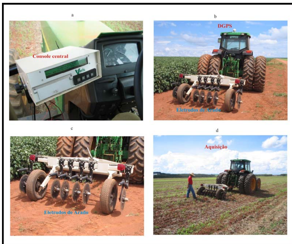
Foto 4.2 - Fotos mostrando o equipamento Veris 3100. a) o console central que gerencia a aquisição, b) visão geral dos eletrodos de discos e do DGPS montados no trator, c) detalhe dos eletrodos de discos e d) equipamento adquirindo dados.
