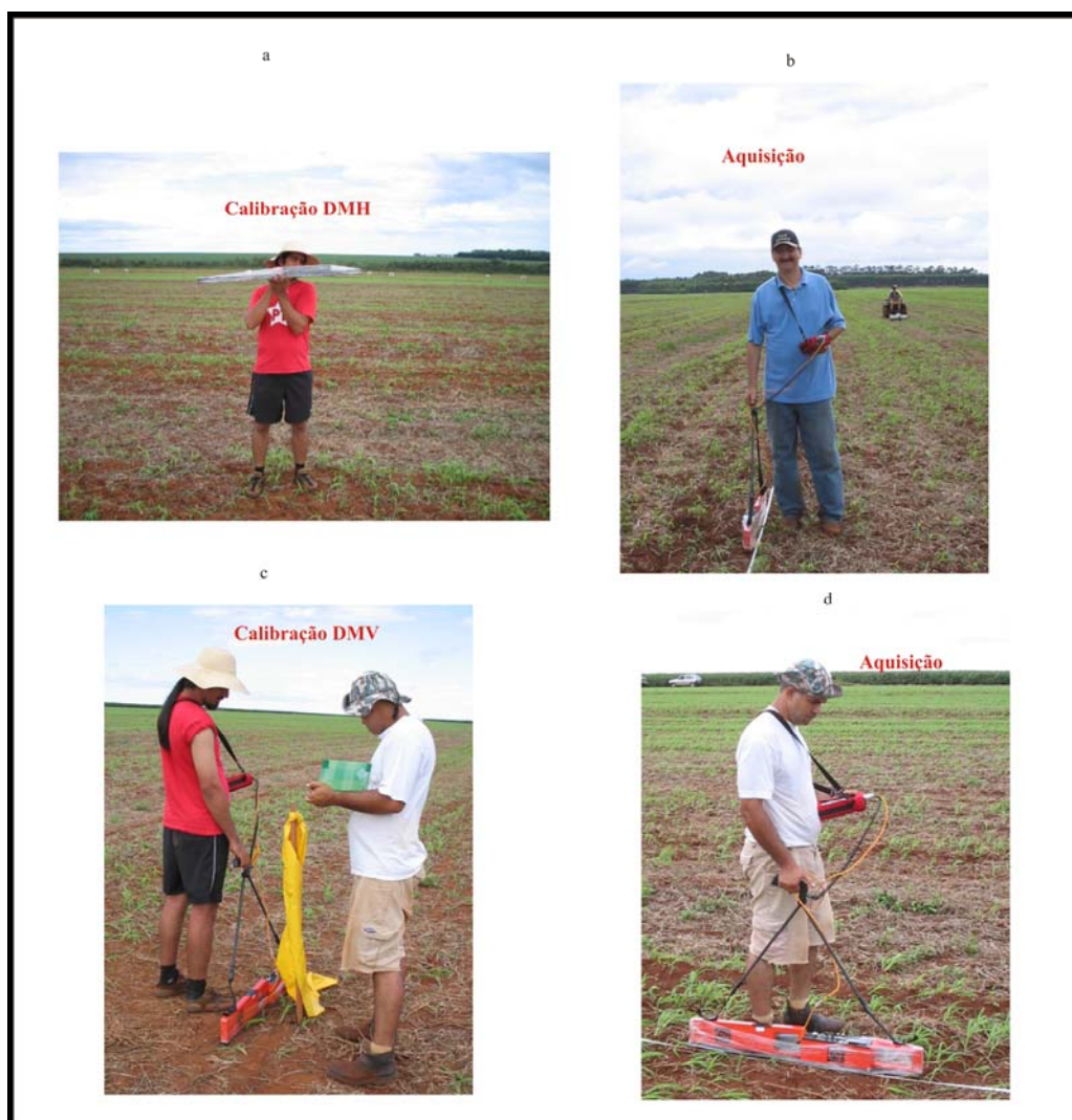
Foto 4.4 - Aquisições com equipamento EM38. a) calibração do equipamento no dipolo magnético horizontal, b) aquisição dos dados, com auxílio da trena, c) reocupação da estação base, mostrando a calibração com dipolo magnético vertical e d) retorno ao levantamento.
