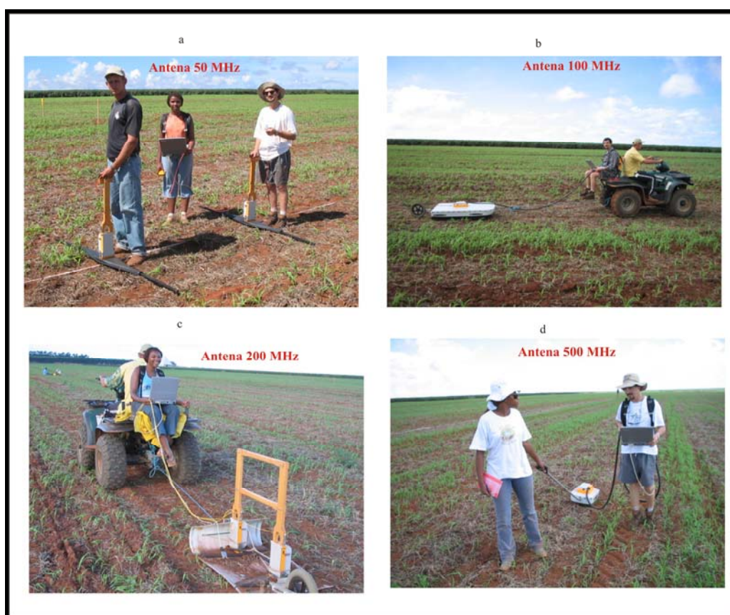
Foto 4.1 - Aquisição dos perfis de reflexão GPR. a) antenas de 50 MHz (não-blindada, modo passo-a-passo), b) antenas de 100 MHz (blindada, modo contínuo), c) antenas de 200 MHz (não-blindada, modo contínuo) e d) antenas de 500 MHz (blindada, modo contínuo).
