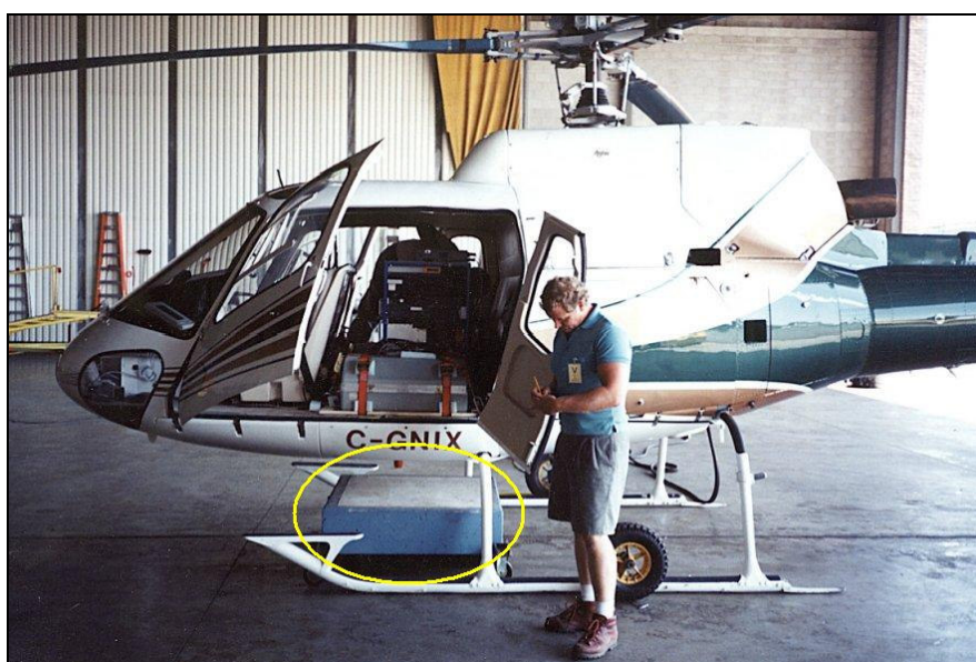
Figura 2.4.3.1 Calibração conjunto de detector gama aerotransportado. No detalhe, bloco de urânio. Figura retirada do Geological Survey of Canada.
