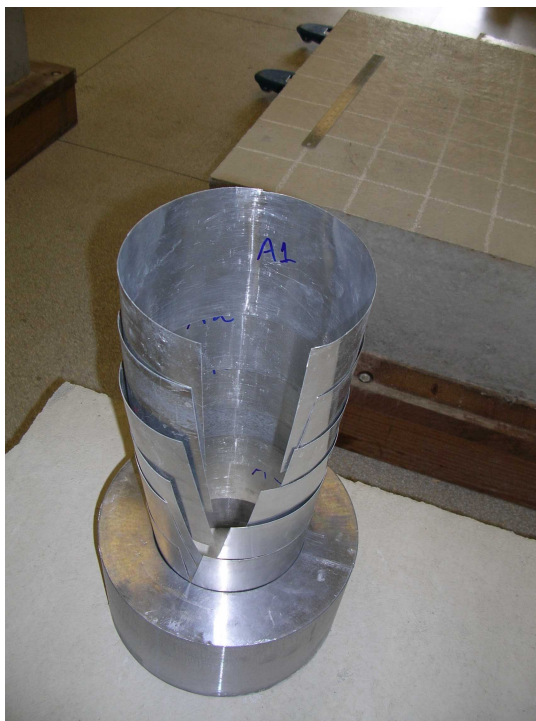
Figura 4.1.2.3 As várias camadas de alumínio foram montadas aos anéis de chumbo de modo a obter-se uma blindagem mais efetiva da radiação.
