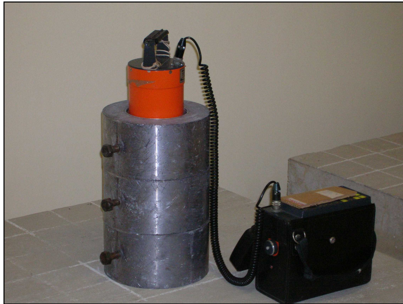
Figura 4.2.1.4 Apresenta a montagem da blindagem durante as medidas sobre a superfície dos blocos de calibração.
