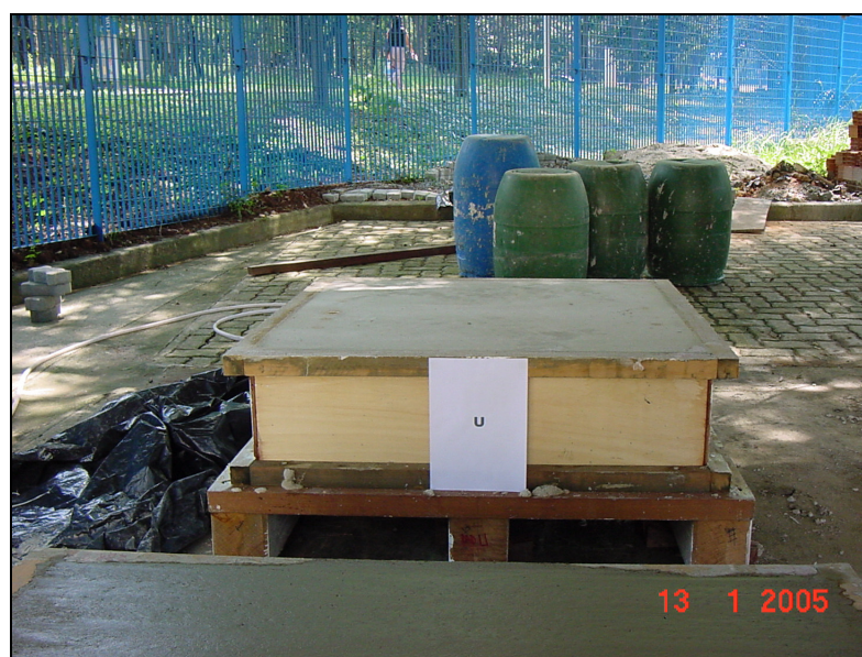
Figura 3.4.2 Bloco de U em fase de cura.
