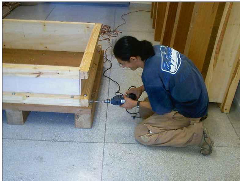
Figura 3.2.1.1 Fixação das laterais ao suporte de madeira.
