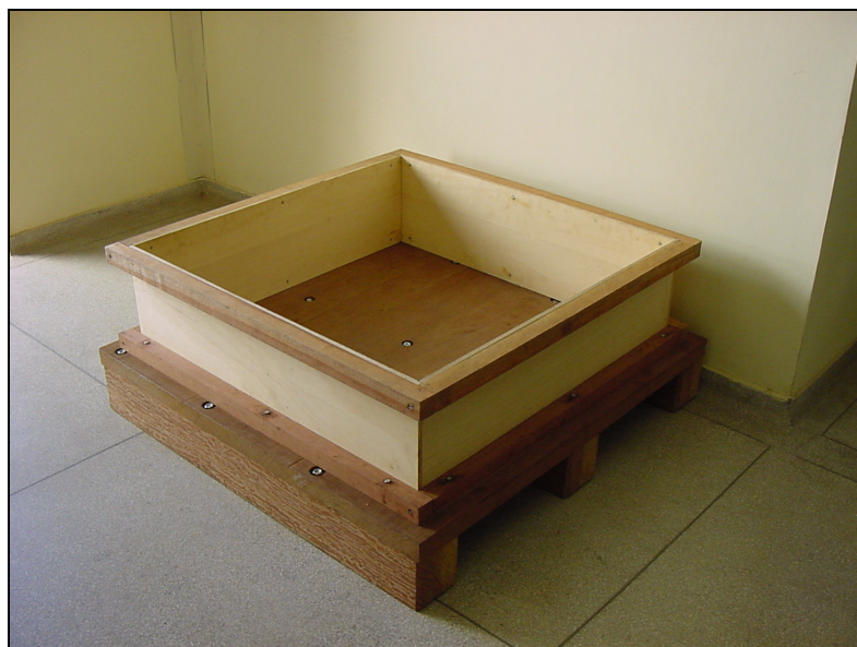
Figura 3.2.1.2 Aspecto final do molde de madeira inteiramente montado.
