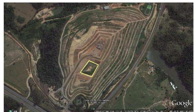
Figura 1 – Localização esquemática do aterro sanitário Delta A, próximo a Rodovia dos Bandeirantes, com destaque para a célula experimental no topo do aterro, com as linhas de perfil realizadas com o arranjo dipolo-dipolo, espaçamento entre eletrodos de 5 m para as linhas C3 e C4, e de 2,5 m para a C5.
