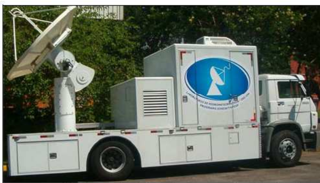
Figura 2.1: Foto do radar meteorológico móvel banda X Doppler de dupla polarização (MXPOL) do Laboratório de Hidrometeorologia (LabHidro) do Instituto de Astronomia, Geofísica e Ciências Atmosféricas (IAG) da Universidade de São Paulo (USP). Fonte: Pereira Filho et al. (2007)
