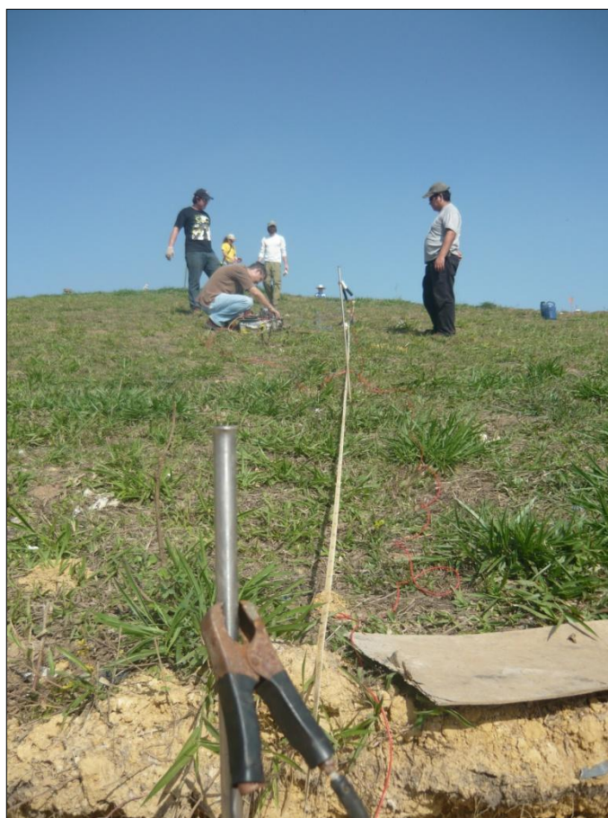
Figura 5.2 Aplicação das técnicas CE e IP em uma das linhas da célula experimental.
