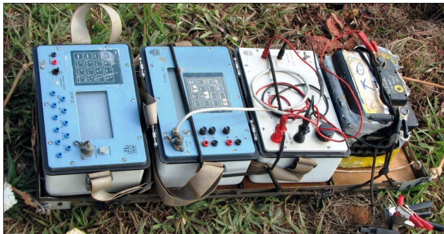
Figura 5.1 Syscal R2, Elrec Pro e conversor de voltagem e bateria 12 V utilizados na aquisição com a técnica de caminhamento elétrico.
