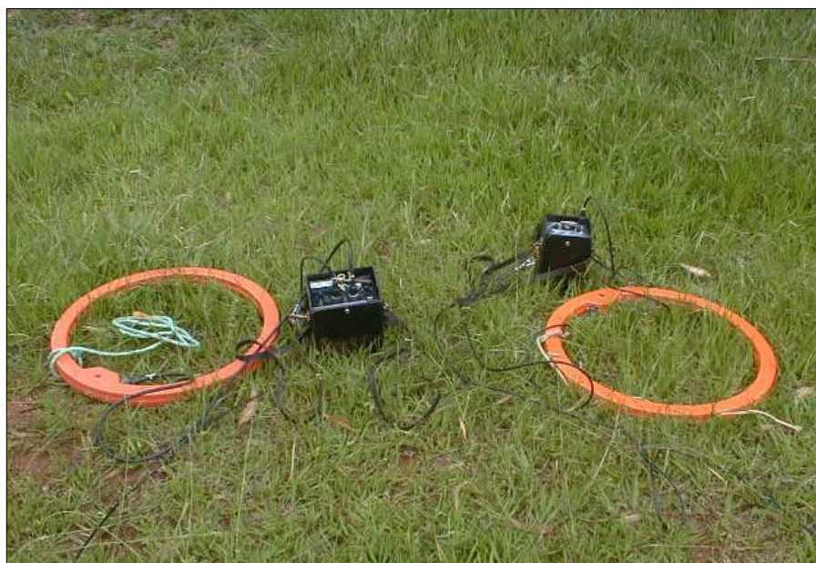
Figura 5.4 Equipamento EM 34, composto por bobina transmissora, bobina receptora, módulo de controle e transmissão de corrente e módulo de leitura.
