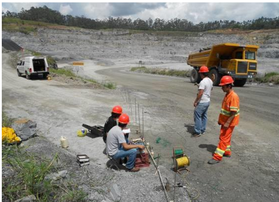
Figura 5.3: Esquema de campo mostrando os dois eletrodos porosos em frente aos equipamentos e eletrodos metálicos ao seu redor.
