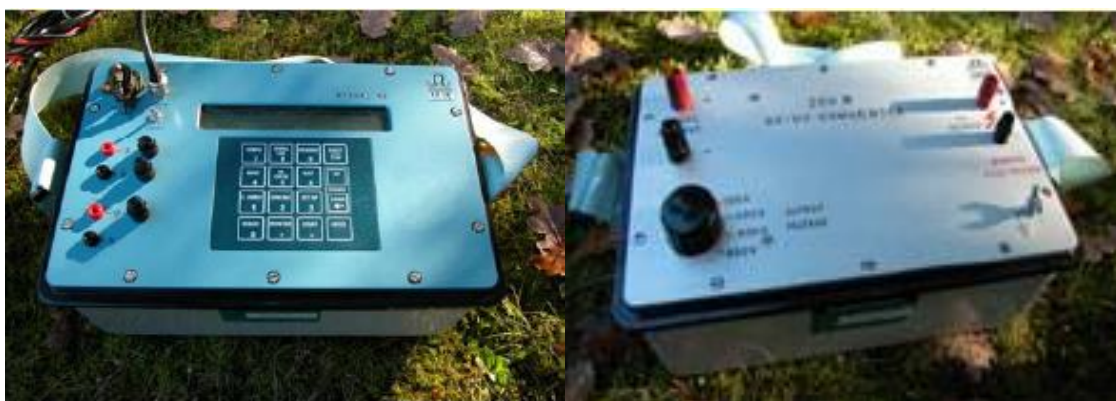
Figura 5.1: À esquerda a unidade do Syscal R2 e a direita a fonte de alimentação do Syscal.
