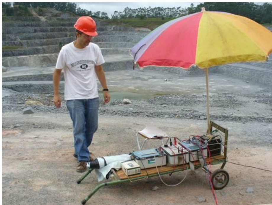
Figura 5.2: Esquema de campo levando todos os aparelhos necessários para realizar as medidas de SEV e CE.
