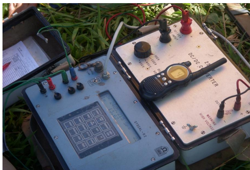
Figura 5.2: Syscal R2 e conversor de voltagem, utilizado na aquisição com a técnica de sondagem elétrica vertical.
