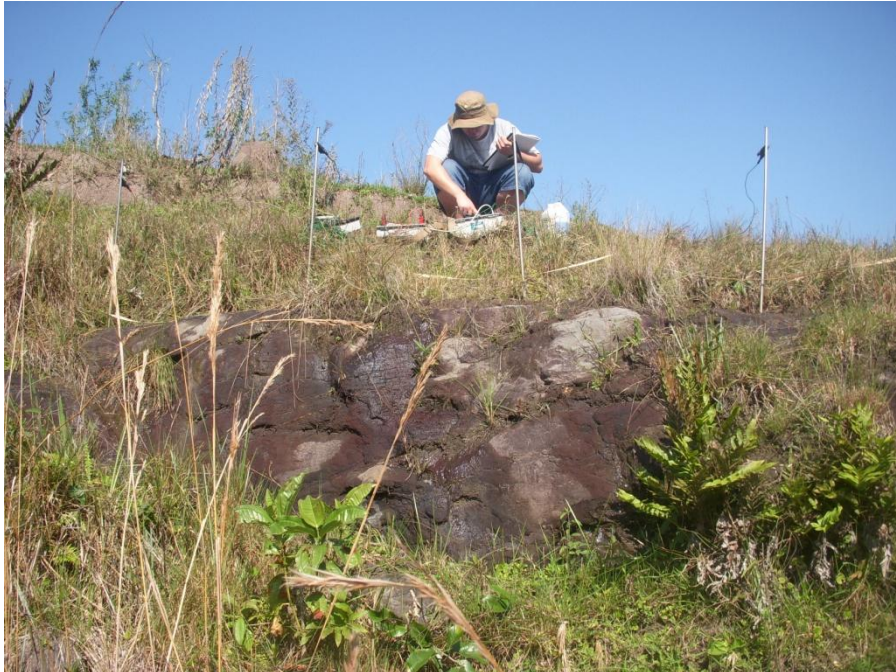
Figura 6.22: Medição em afloramento de arenito asfáltico com arranjo Wenner.
