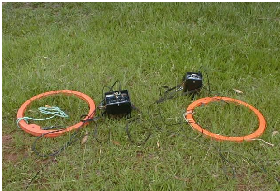
Figura 5.4: Equipamento EM 34, composto por bobina transmissora, bobina receptora, módulo de controle e transmissão de corrente e módulo de leitura.
