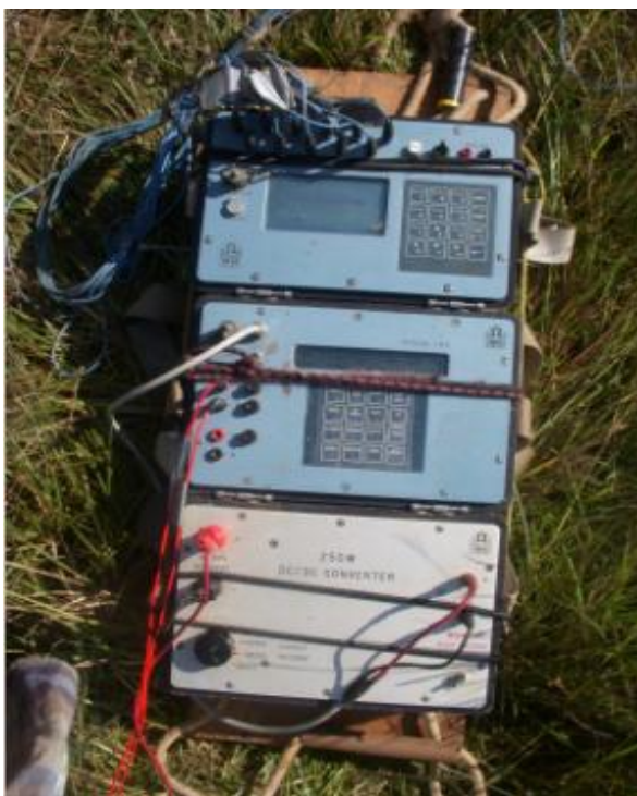
Figura 5.1: Syscal R2, Elrec Pro e conversor de voltagem, utilizados na aquisição com a técnica de caminhamento elétrico.
