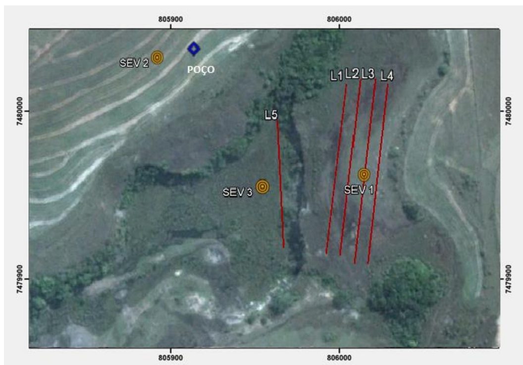
Figura 5.6: Esquema da distribuição dos caminhamentos elétricos e sondagens elétricas realizados. As linhas L1 a L5 representam os CE, as Sevs estão marcadas por círculos amarelos e o poço perfurado pela Petrobras em azul.
