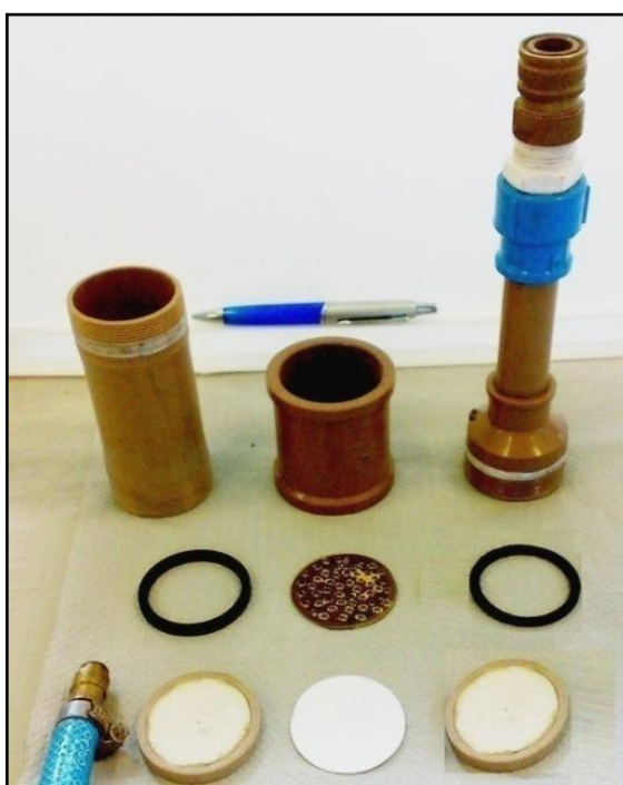
Figura 5.1 – Conjunto de elementos pertencentes ao sistema de filtração
