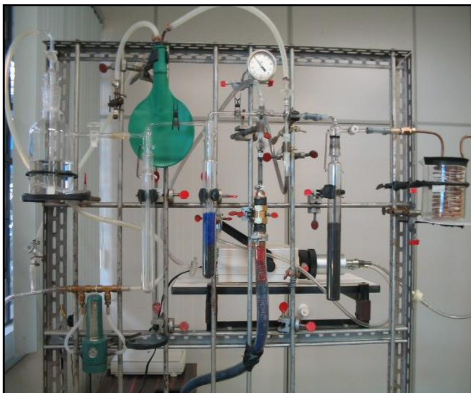
Figura 5.4 – Arranjo experimental (linha de extração e unidade aquisitora de dados)
