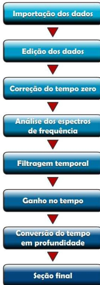
**Figura 4. 12 – Fluxograma das etapas de processamento GPR.**
