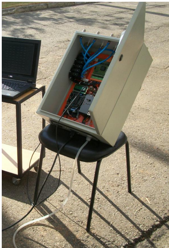
Figura 3.3 – Amostrador Tupiniquim, visíveis estão a placa de controle e temporizadora, assim como as válvulas de controle de amostragem.
