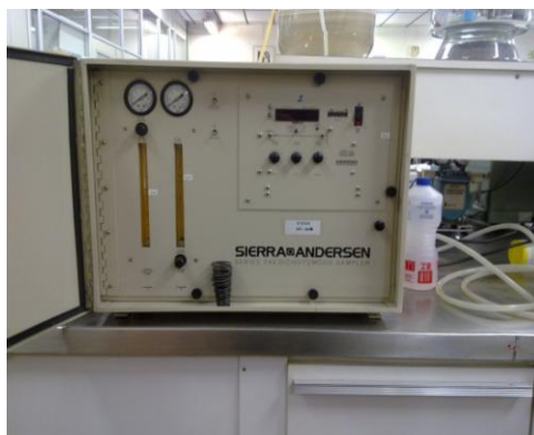
Figura 3.7 – Amostrador Sierra-Andersen, ilustrando o controle de fluxos (fino e grosso) para funcionamento do impactador virtual
