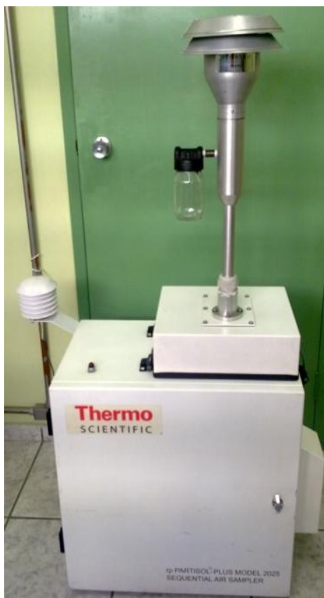
Figura 3.2 - Amostrador dicotômico de material particulado Partisol Thermo Scientific. Estrutura com Inlet (topo), caixa intermediária contendo impactador virtual, corpo com o amostrador, temporizador e armazenagem de filtros
