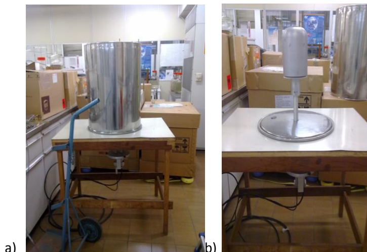
Figura 3.6 – Câmara de ressuspensão da CETESB: a) com o cilindro; b) sem o cilindro, evidenciando o inlet, tamanho de corte 10 \mu\text{m} .
