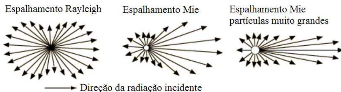
Figura 2.4.2. Distribuição da radiação espalhada: (esquerda) por partículas muito pequenas com relação ao comprimento de onda da radiação incidente; (meio) por partículas maiores; (direita) por partículas muito maiores que o comprimento de onda da radiação incidente (adaptada de Liou, 2002).
