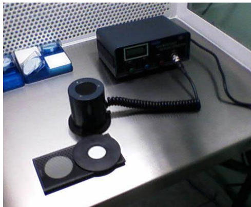
Figura 3.3: Refletômetro usado para a quantificação do BC.
