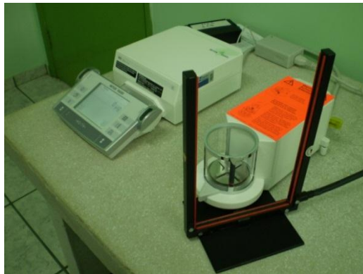
Figura 3.2: Balança com precisão nominal de 1 \mu\text{g} (à esquerda) e o aparelho usado para remover a eletricidade estática dos filtros (à direita).
