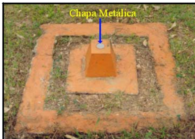
Figura 4.4 – Marco de concreto utilizado na implantação de RNs
