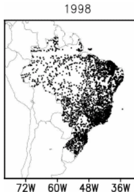
Figura 2.1 –Distribuição espacial dos postos pluviométricos utilizados na construção dos campos de precipitação em pontos de grade de 1^\circ \times 1^\circ (latitude-longitude) no ano 1998. Fonte: Silva et al. (2007).
