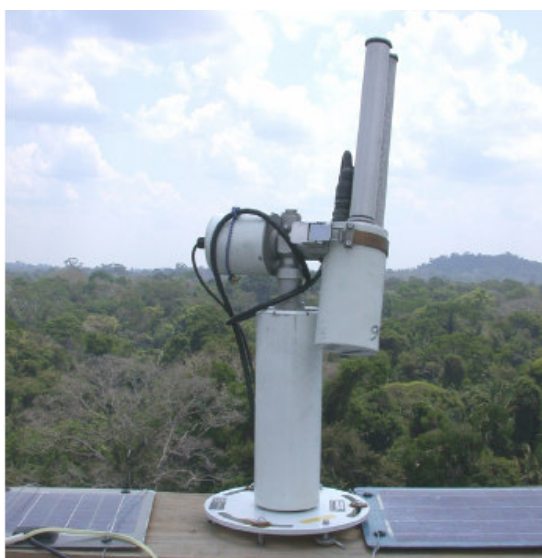
Figura 3.2.1: Foto mostrando um radiômetro CIMEL em operação. Figura obtida de Procópio (2005).
