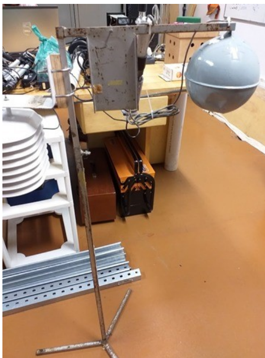
Figura 24 – Termômetro de globo cinza montado - modelo CAMPBELL SCIENTIFIC BLACK GLOBE - L - cedido pela FAU - USP utilizado nos experimentos
