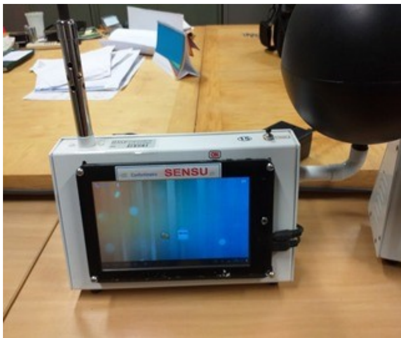
Figura 22 – Confortímetro modelo SENSU cedido pela FAU - USP utilizado nos experimentos
