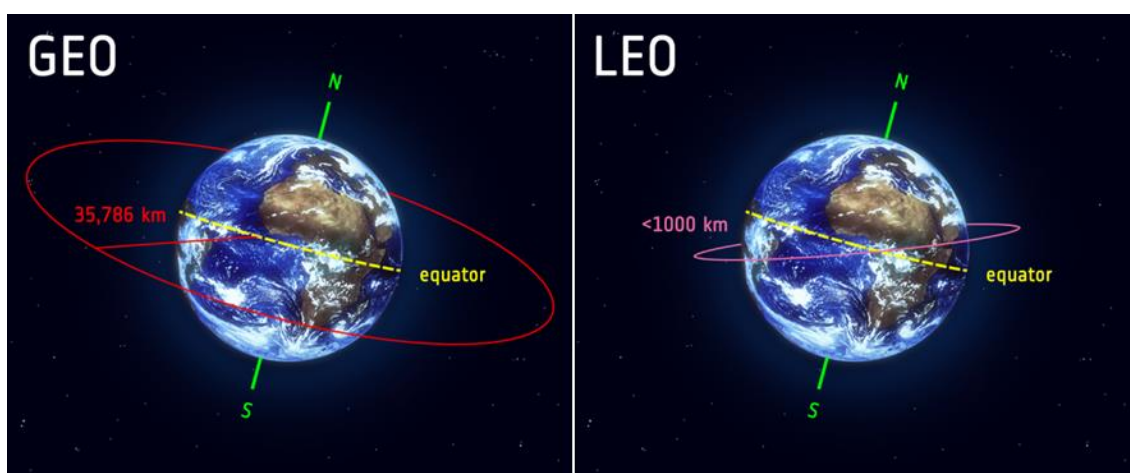
Figura 13 — Órbitas geostacionárias (GEO) e órbitas baixas (LEO).
