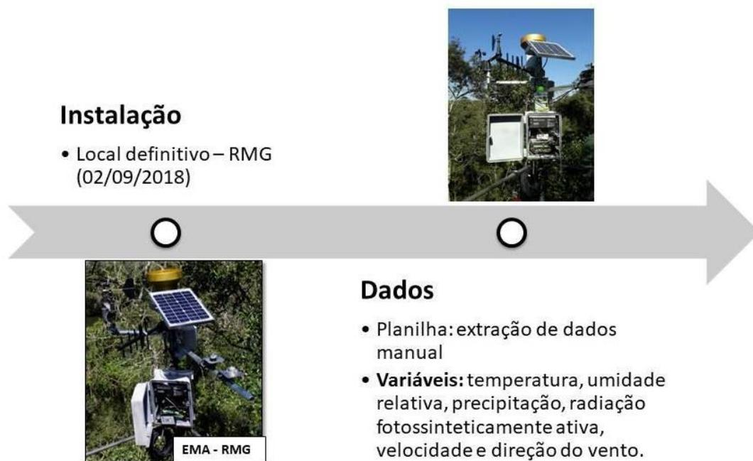
**Figura 3.12.** Estação Meteorológica Automática (EMA) instalada no RMG, descrição da instalação, extração dos dados e variáveis.
