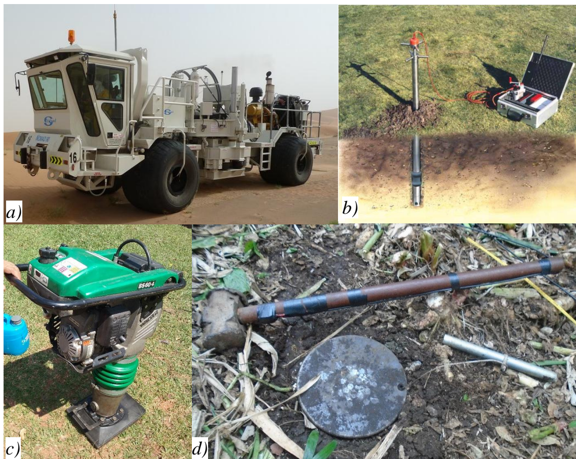
Figura 4.1: Fontes sísmicas a) Vibroseis Nomad 90 Neo da Sercel; b) Seismic Impulse Source System (SISSY) da Geosym; c) compactador de solo tipo 'Wacker'; d) marreta.
