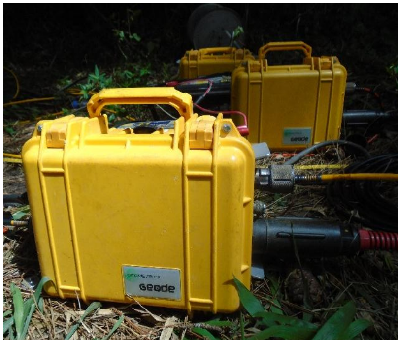
Figura 4.6: Sismógrafo Geode-Geometrics de 24 canais com conversor A/D de 24 Bits.
