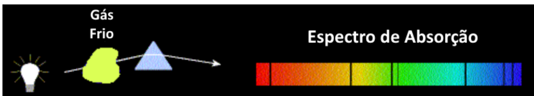
Figura 28 – Esquema ilustrativo de um gás frio na frente de uma fonte (lâmpada) gerando um espectro de absorção 19 .
