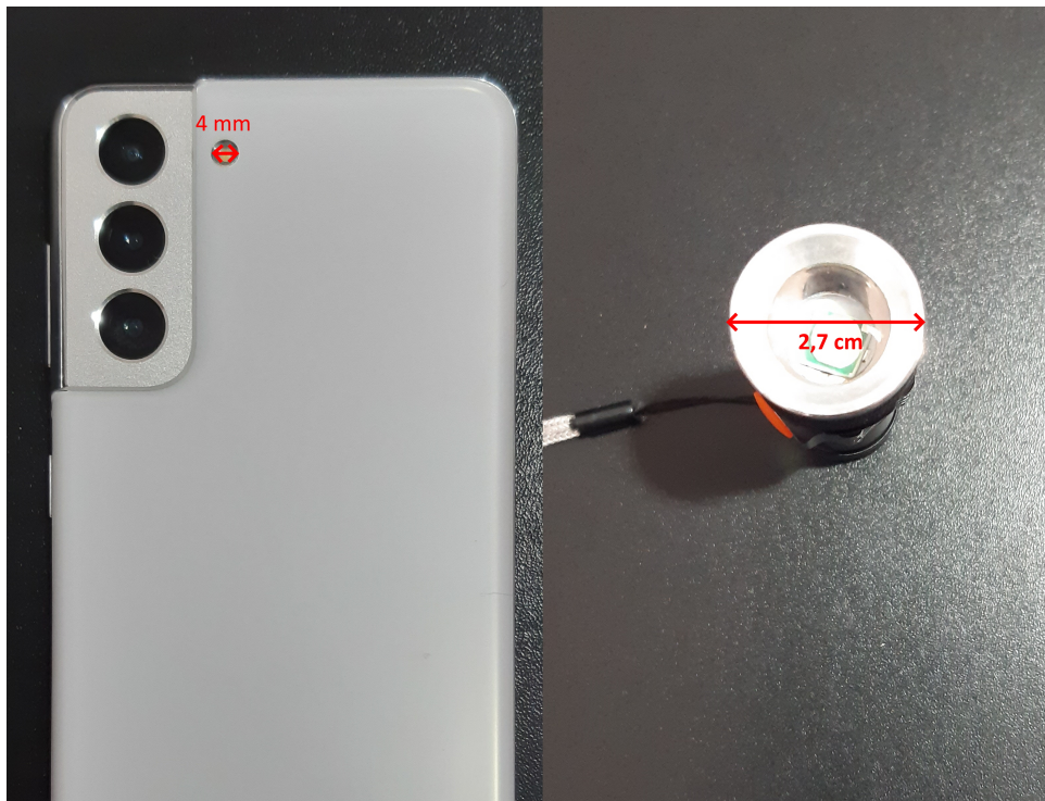
Figura 16 – Medidas de abertura das duas fontes de luz utilizadas nos Experimentos 2 e 3. Do lado direito da imagem, apresenta-se a medida de abertura da saída de luz da Lanterna Tática (2,7 cm), já do lado esquerdo apresenta-se a medida de abertura da saída de luz da Lanterna do Galaxy S21 (4 mm).
