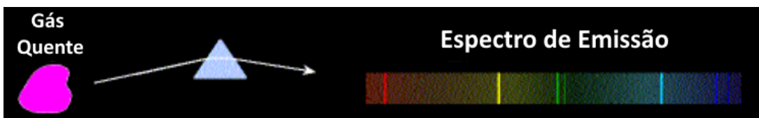
Figura 27 – Esquema ilustrativo de um gás quente e pouco denso gerando um espectro de emissão 19 .
