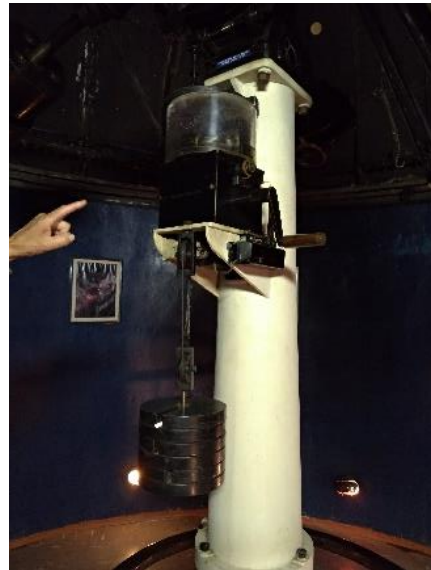
Figura 3.14 - Sistema mecânico para compensar a rotação da Terra
