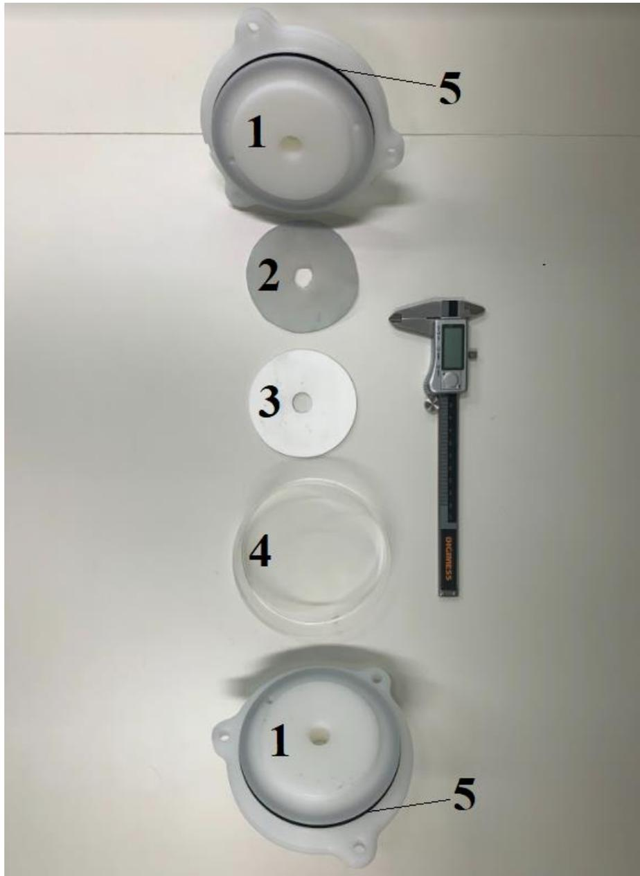
*Figura A 2. Foto dos componentes separados de uma das células. 1 – peças de resina, 2 – lâmina delgada de silicone, 3 – amostra porosa, 4 – membrana de plástico transparente, 5 – o-rings de borracha*
