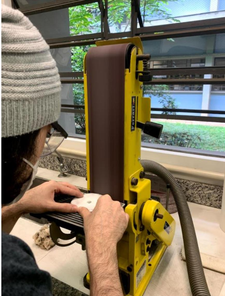
*Figura A 9. Processo de lixamento final das amostras*
