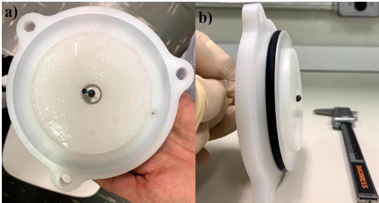
*Figura A 3. Foto da segunda proposta para contenção de vazamentos dentro da câmara utilizando silicone em gel. a) vista frontal, o silicone foi espalhado por toda essa superfície circular interna que entraria em contato com a amostra, b) vista lateral*
