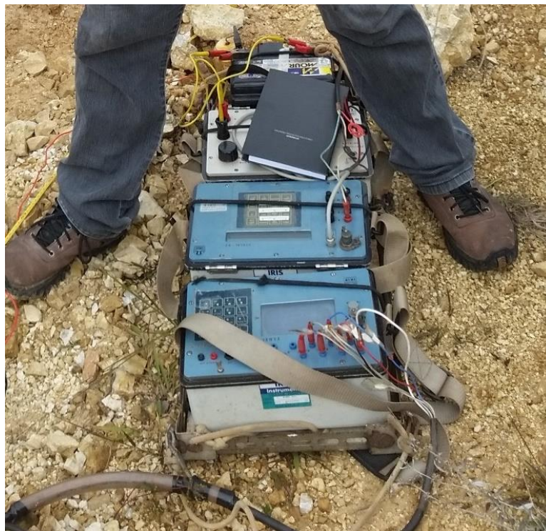
Figura 5.2: Equipamentos utilizados na aquisição dos dados. De cima para baixo: bateria 12V, ElrecPro, Sycal R2, Conversor DC DC.
