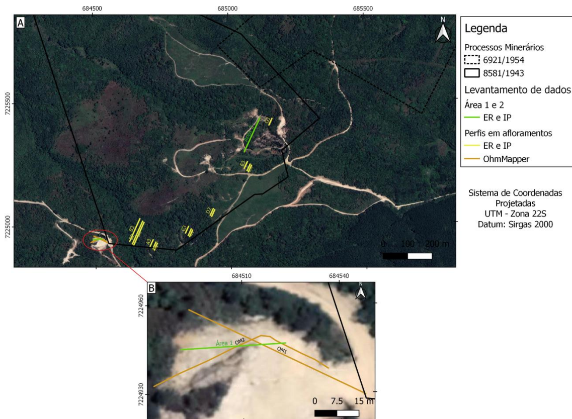
Figura 5.6: Perfis realizados na área de estudo sobre imagem de satélite. Em A: área de estudo, B: Destaque para perfis com OhmMapper.
