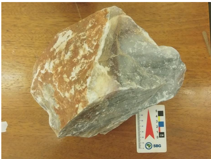
Figura 5.7: Amostra coletada em campo e utilizada na medição da resistividade em caixa
