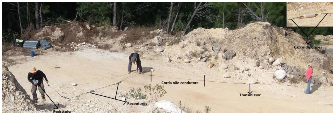
Figura 5.3: Equipamento OhmMapper em utilização no campo e com destaque de seus elementos
