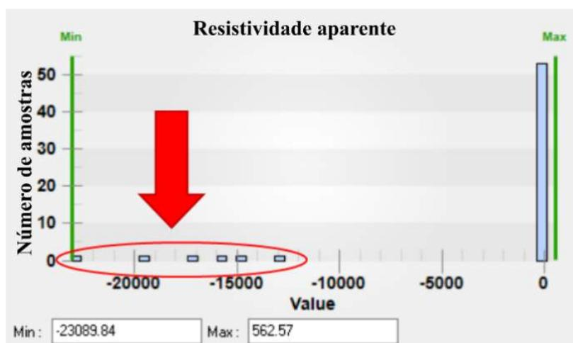
**Figura 4.4:** Exemplo de conjunto de amostras de um perfil de ERT com valores negativos de resistividade aparente destacados em vermelho.
