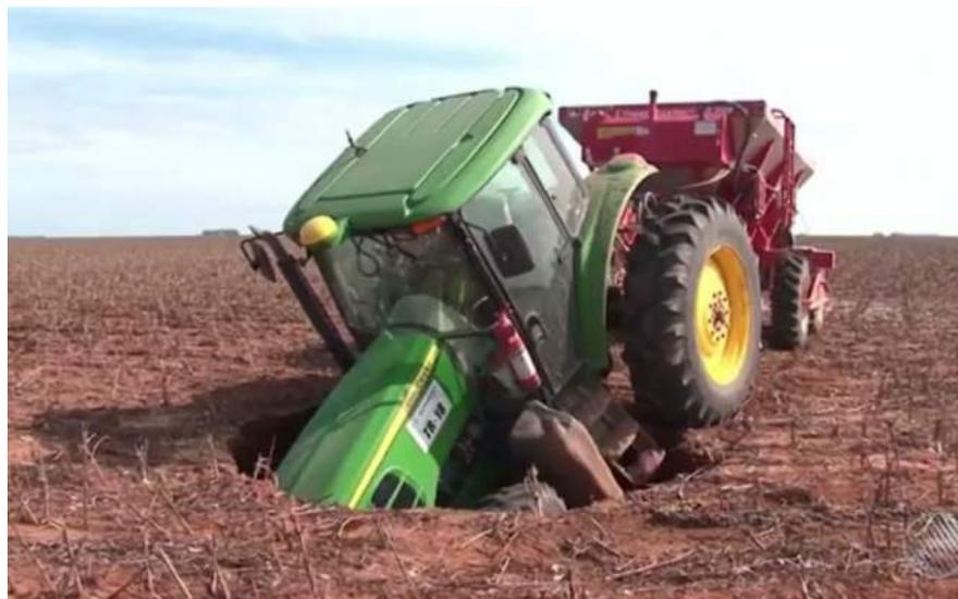
**Figura 1.1:** Máquina agrícola que foi ‘engolida’ pelo solo em uma lavoura de milho na Bahia. Fonte: adaptado de Bertolancini e Popov (2017).
