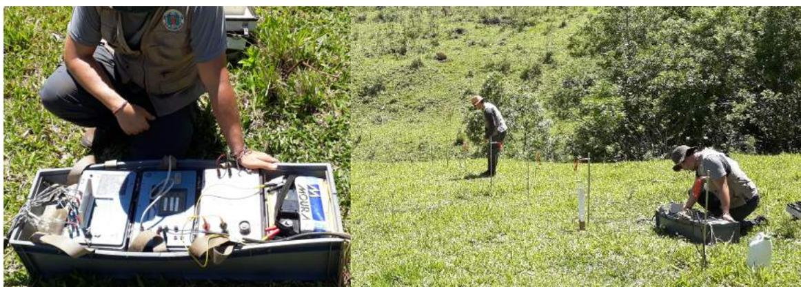
**Figura 4.1:** Fotografia da aquisição de dados de ERT realizada na segunda campanha de aquisição de dados e destaque para o sistema de aquisição: à esquerda o Elrec Pro (receptor), ao centro o Syscal R2 e um conversor de voltagem (transmissor) e à direita uma bateria de 12 V (fonte).
