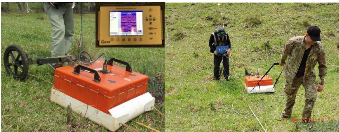
**Figura 4.6:** Fotografia da aquisição de dados de GPR realizada na segunda campanha de aquisição de dados e destaque para o módulo de aquisição SIR3000 e para a antena de 200 MHz.
