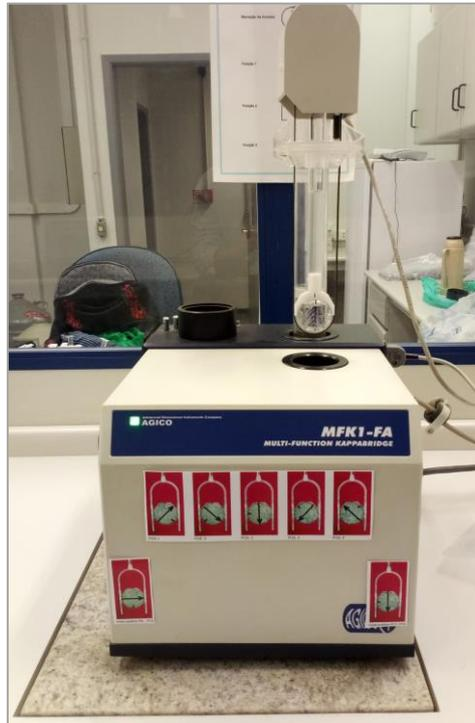
Figura 38: Equipamento multifuncional Kappabridge MFK1-FA utilizado para aquisição da ASM.
