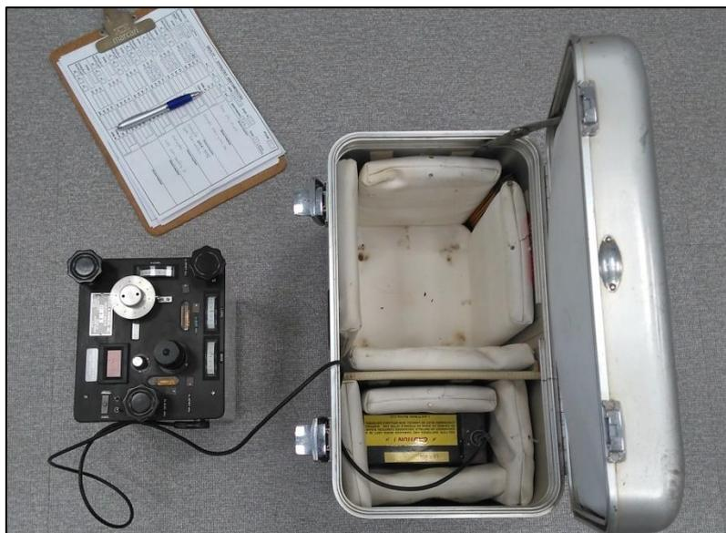
Figura 10: Gravímetro diferencial LaCoste & Romberg modelo G (número de série 965) utilizado em campo.
