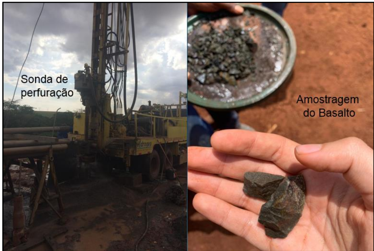
Figura 71 – Sonda da perfuração em operação e amostragem do basalto do Sistema Aquífero Serra Geral.
