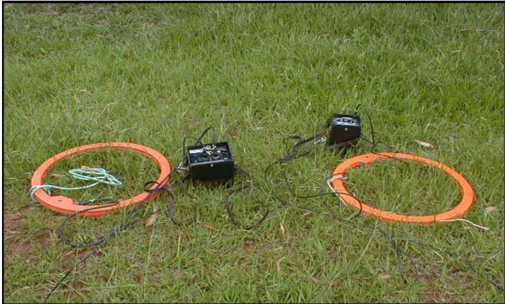
Figura 21 – Equipamento EM-34 da empresa canadense Geonics. Bobina transmissora T_x à esquerda e bobina receptora R_x à direita (SOUZA, 2007).
