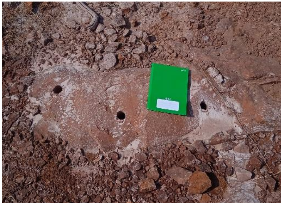
Figura 2.4 – Arenito róseo, localizado na Chapada dos Caiabis. Furos provenientes da amostragem paleomagnética. Fonte: autoria própria.
