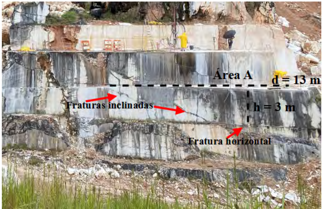
Figura 6.20. Fotografia da frente de lavra da pedreira ativa. Na imagem, é possível visualizar parcialmente a bancada de mármore que compreende a Área A.
