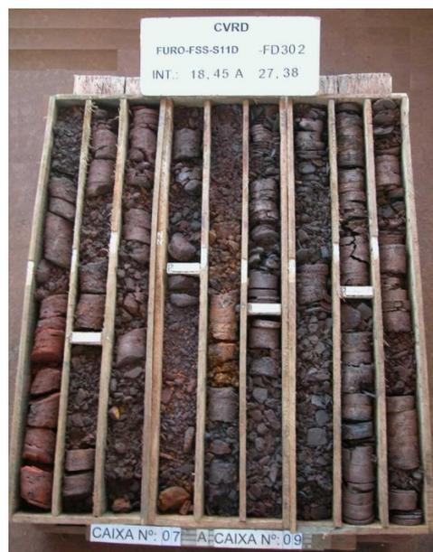
Figura 2 - Caixas de testemunhos de rocha utilizados para descrição geológica, com indicação da denominação do furo de sondagem e do intervalo de profundidades correspondente.
