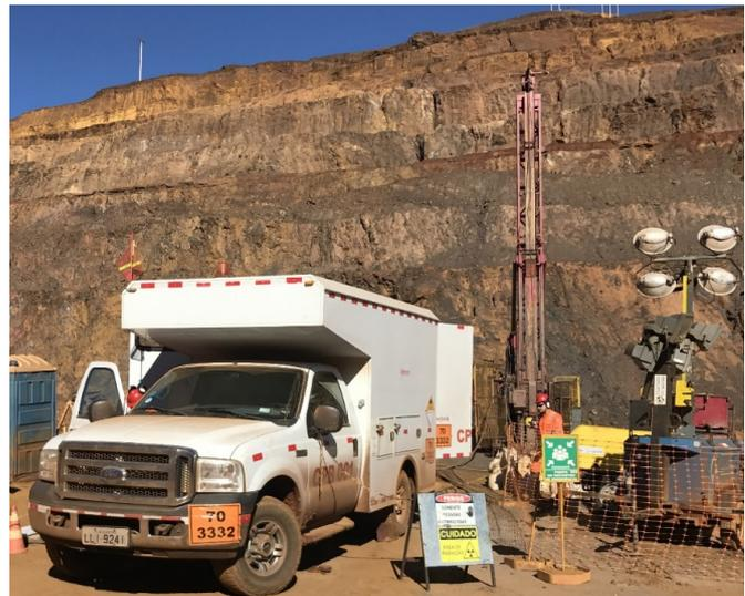
Figura 3 - Elementos do processo de perfilagem geofísica: Esquemático (esquerda) e unidade móvel de perfilagem em uma praça de sondagem geológica para mineração (direita) (imagens cedidas pela Comprobe/Vale S.A.)
