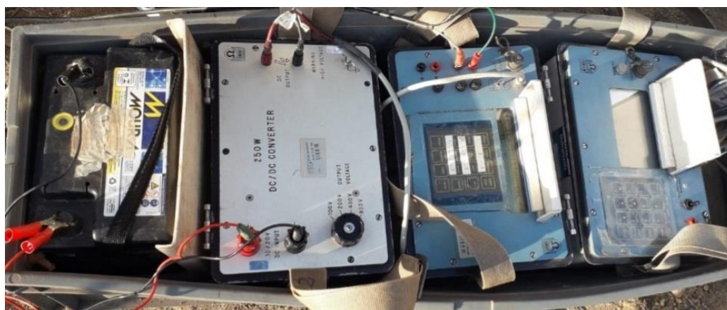
Figura 17 – Esquema de utilização do equipamento Syscal Pro, com conversor e bateria, empregado no levantamento das linhas de caminhamento elétrico
