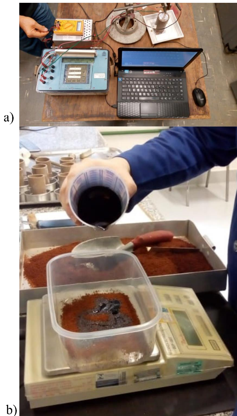
Figura 32. Experimento de medida de resistividade das amostras. a) Sistema desenvolvido para medição. b) Processo de adição de creosoto nas amostras.
