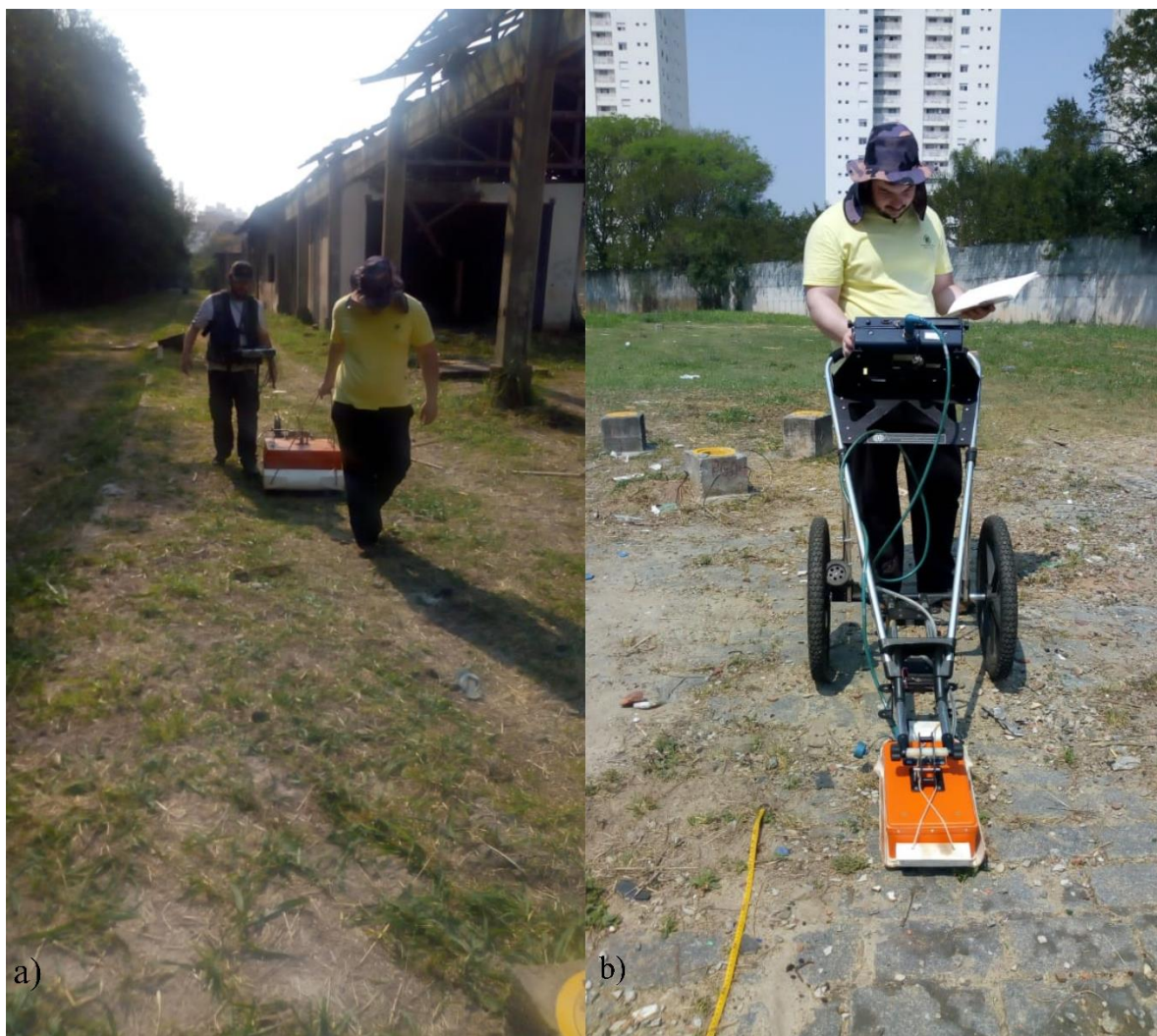
Figura 37. Aquisições GPR na área de estudo. a) Antena de 200 MHz. b) Antena de 900 MHz.
