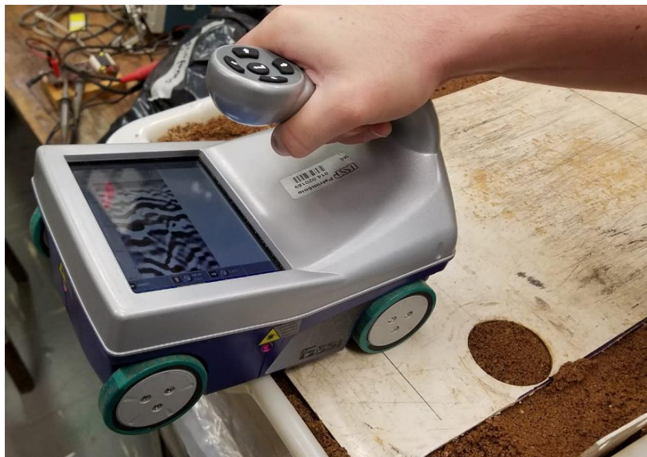
Figura 35. Aquisição sobre a caixa de areia utilizando a antena GPR GSSI de 2600 MHz.
