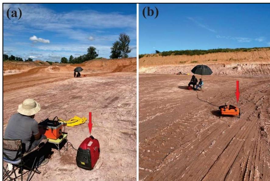
Figura 4.4 – Aquisição de dados TDEM realizada na mineradora de areia. Fonte: autor. Setas indicando (a) gerador e (b) bobina receptor 3D.
