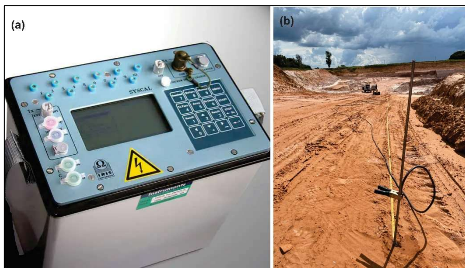
Figura 4.1 – (a) Syscal Pro utilizado na pesquisa de campo; (b) eletrodo metálico. Fonte: (a) Iris Instrument; (b) autor.
