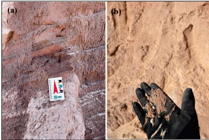
Figura 2.6 - (a) estratificação cruzada com presença de ritmitos; (b) friabilidade da camada de arenito.
