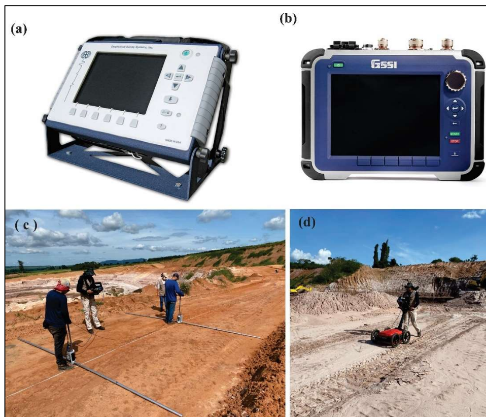
Figura 4.2 – (a) SIR 3000 usado com a antena de 270 MHz; (b) antena MLF de 40 MHz; (c) SIR 4000 usado com a antena de 270 MHz; (d) antena de 270 MHz. Fonte: (a) e (b) GSSI ( www.geophysical.com ), (c) e (d) autor.
