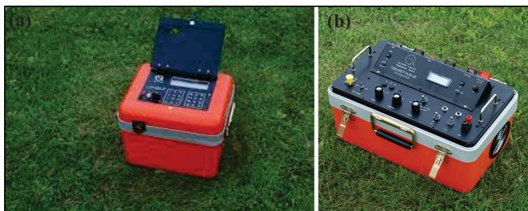
Figura 4.3 – Receptor Protem-D; transmissor TEM 57–MK2. Fonte: Geonics (2023).
