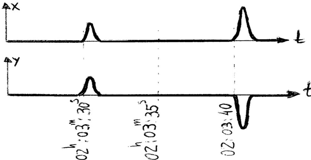
3. Os sismogramas abaixo mostram as componentes Z, N e E do movimento do chão numa estação sismográfica em Sobral, CE (UFRN). Sinal positivo indica movimento do chão p/ cima, p/ o Norte e p/ o Leste, respectivamente. Amplitude negativa significa movimento para baixo, p/ o Sul e p/ o Oeste. A velocidade da onda P é  $V_p = 6,0$  km/s e a da onda S é  $V_s = 3,5$  km/s.
